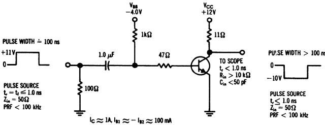
FIGURE 2 – STORAGE TIME TEST CIRCUIT
