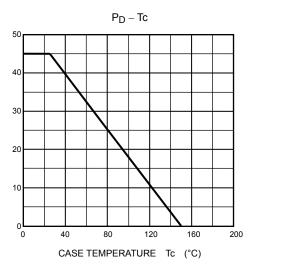
DRAIN POWER DISSIPATION PD (W)
