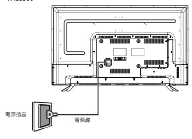
將電源線的另一端連接到電源插座上·若電源插座上有電源開關的話· 請打開電源開關。 顯示器將會進入待機狀態·且位於顯示器正面下方的 電源指示燈將會亮紅色。
