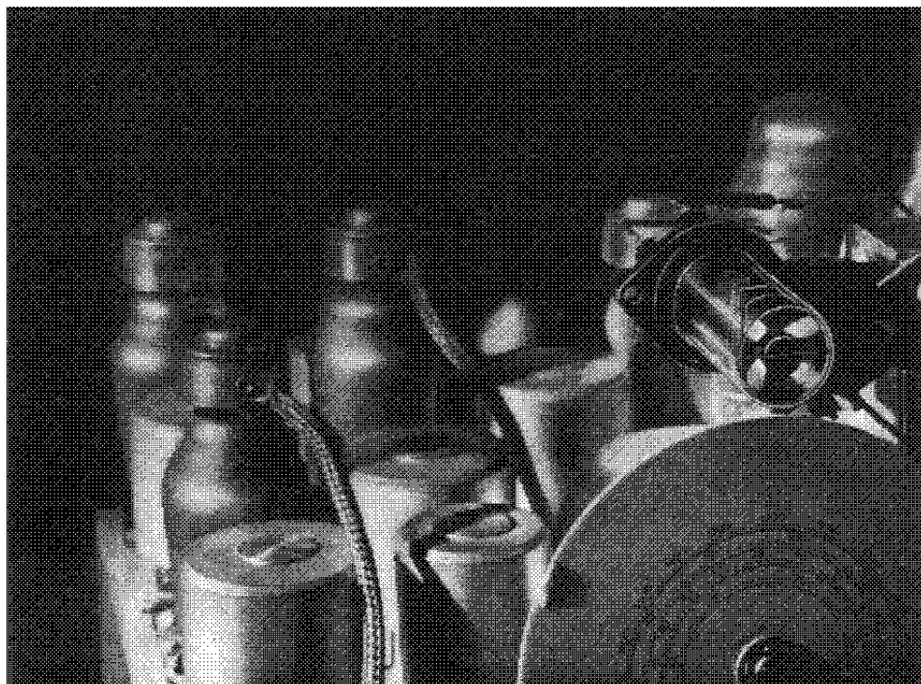
Le trèfle cathodique constitue le moyen idéal pour contrôler l'accord exact du récepteur sur l'émission désirée.
