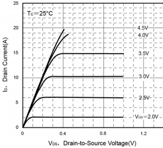
图1. 典型输出特性 ( $T_c=25^\circ\text{C}$ )
