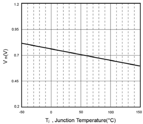
图6. 栅极门限电压与结温的关系
