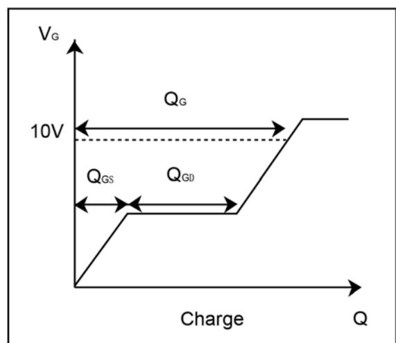
图12. 栅极电荷波形
