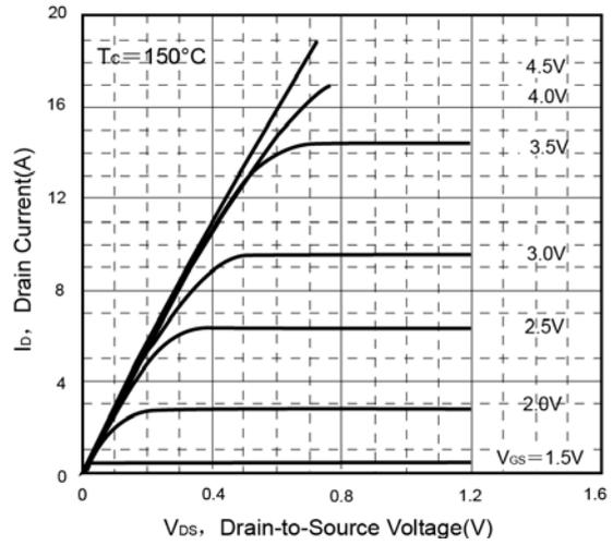
图2. 典型输出特性 ( $T_c=150^\circ\text{C}$ )
