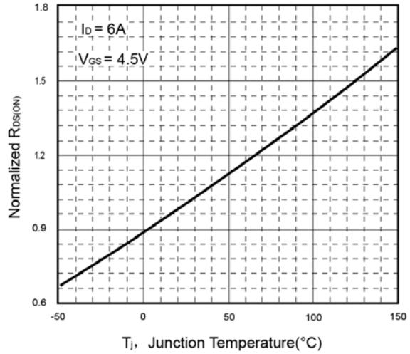
图4. 导通电阻与结温的归一化关系
