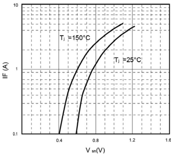
图5. 反向二极管的正向特性
