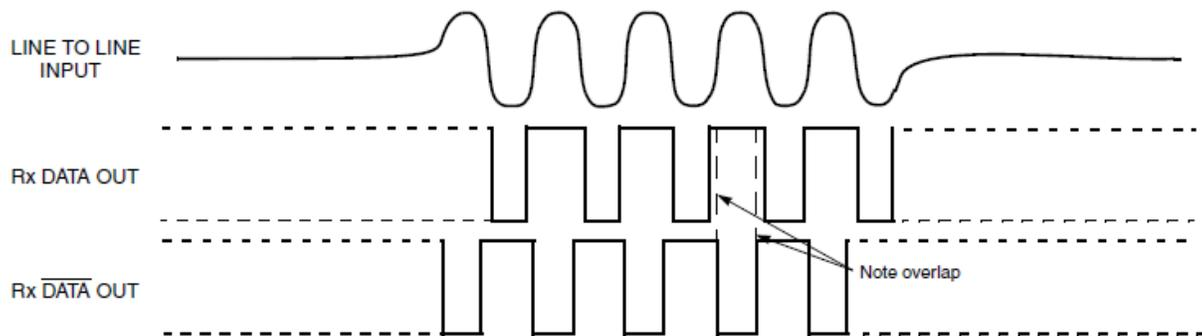
**FIGURE 3 – RECEIVER LOGIC WAVEFORMS**
