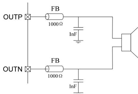
图 8 输出端加磁珠的设计图
