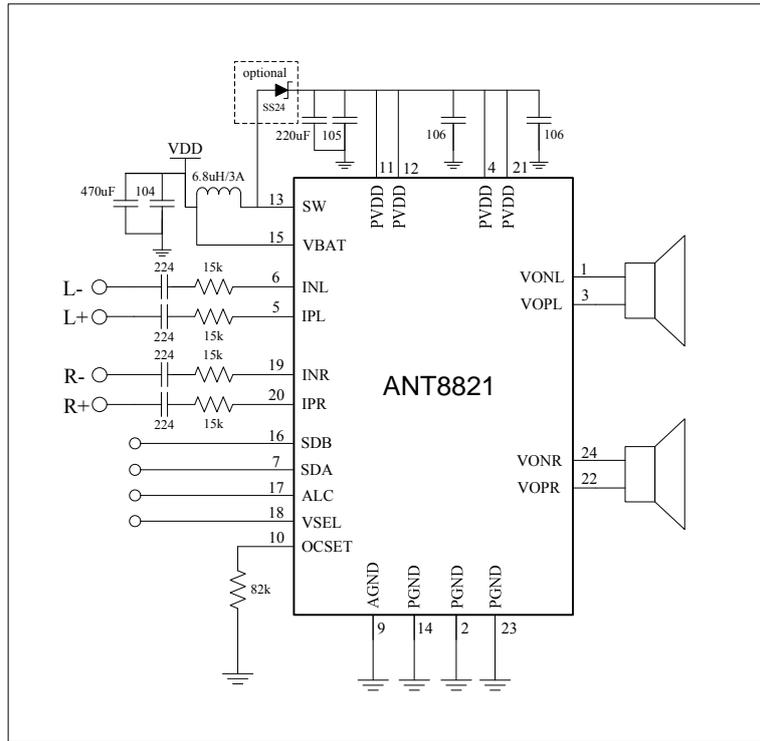
图 5 ANT8821 差分输入工作模式电路图
