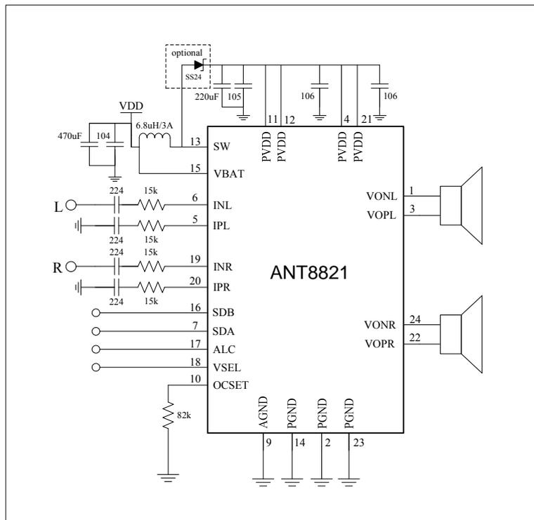
图 4 ANT8821 单端输入工作模式电路图
