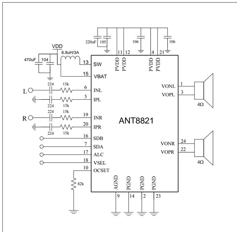
图 6 ANT8821 输出接 4Ω 负载应用电路图
