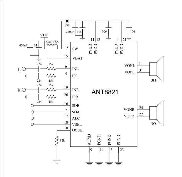
图 7 ANT8821 输出接 3Ω 负载应用电路图
