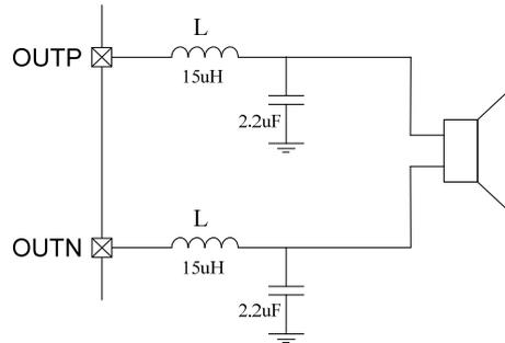
图 9 负载为 4Ω~8Ω 时的 LC 输出滤波器
