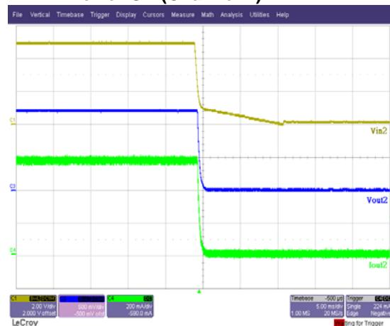
$V_{IN2}=5V$ ,  $V_{OUT2}=1.2V$ ,  $I_{OUT2}=600mA$
