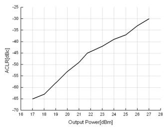
\*\* Test Source : Agilent E4433B (3GPP W-CDMA Test Model-1 64DPCH)
