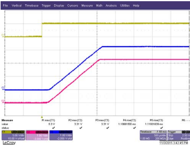
Fig.5 Turn-on Response, VINx=3.3V
