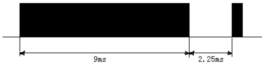
图 9 PT2222 的第二次传送波形 (重复码波形)
