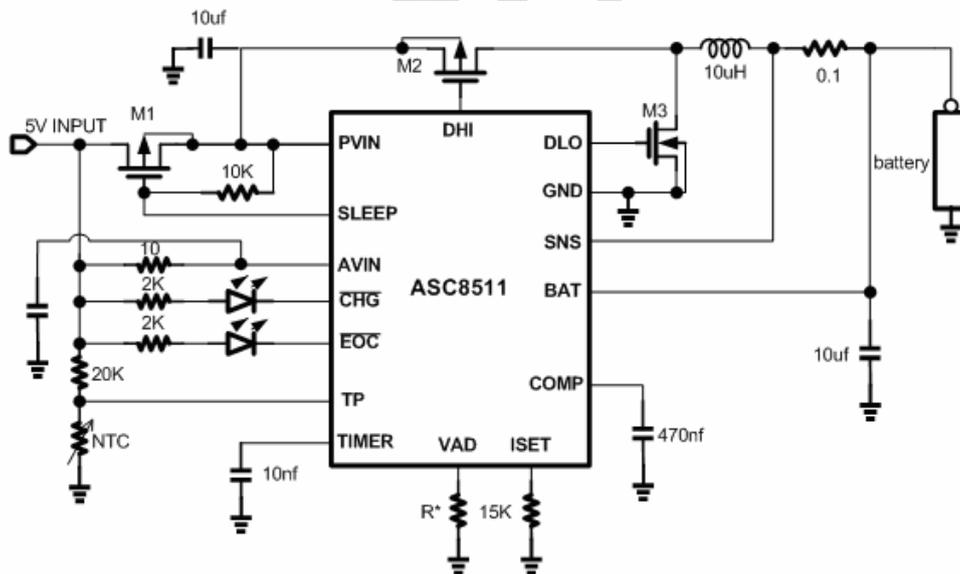
图 1.1、ASC8511 大电流充电典型应用图
