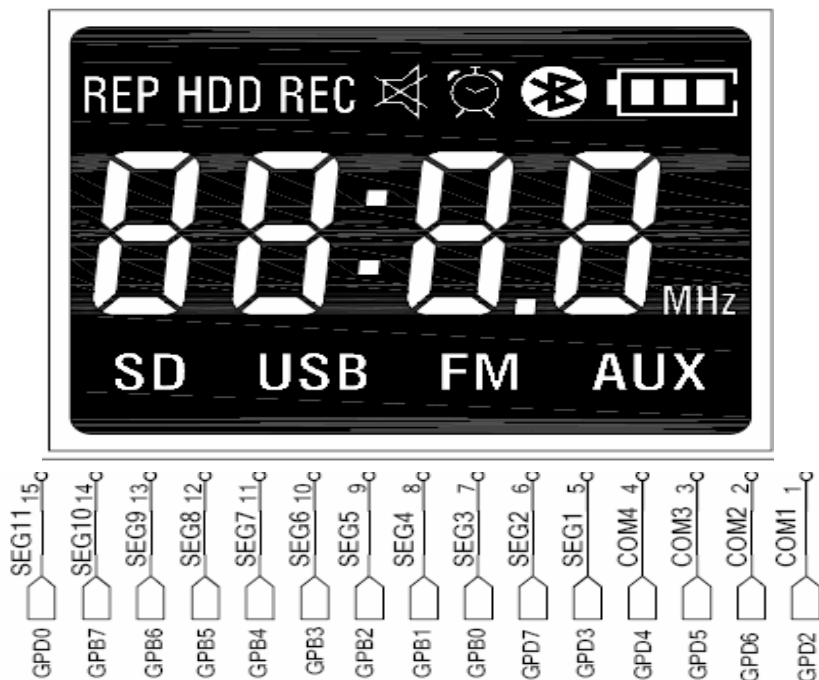
GPIO直驱动LCD屏显示线路
