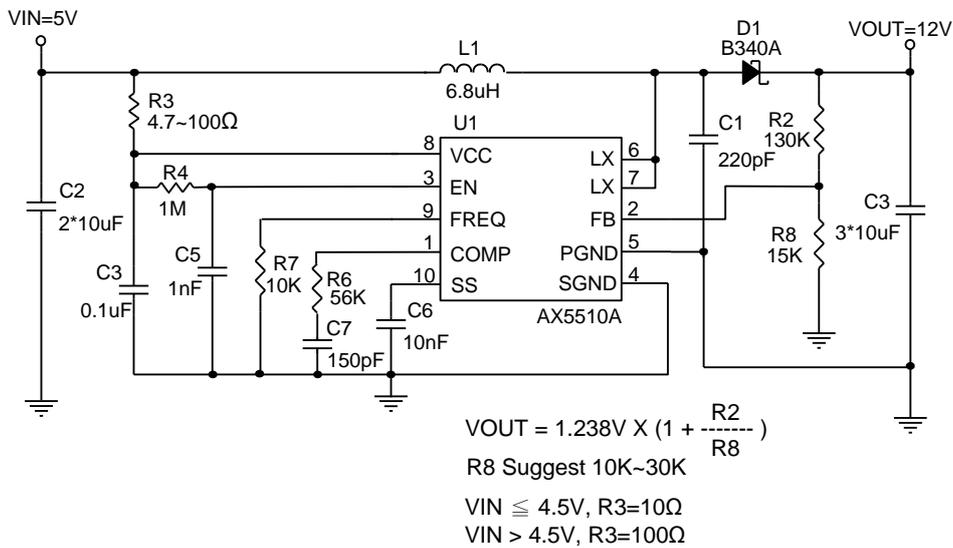
(3) FREQ=High (Frequency=1.2MHz) (SOP-8L/MSOP-8L)
