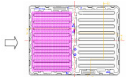
EPE spacer 放於 tray 盤上 左側穴內
