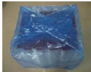
完成堆疊的 tray 放入靜電袋中, 並使用 tape 封口
