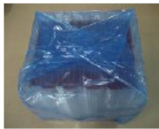
完成堆疊的 tray 放入靜電袋中, 並使用 tape 封口
