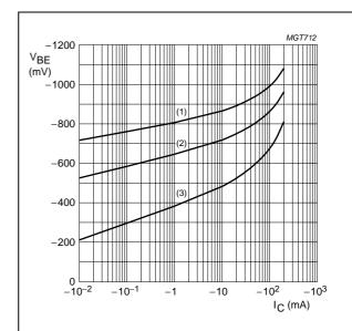
**BC857A;**  $V_{CE} = -5 \text{ V}.$
