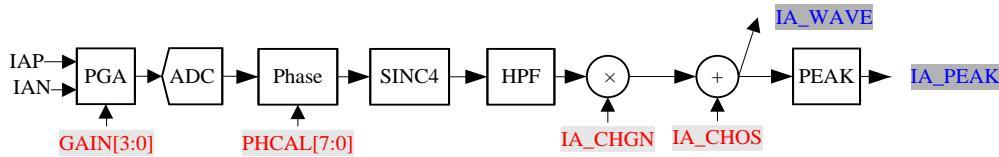
前端波形计算包括增益放大器(PGA)、高精度的模数转换(ADC)、相位校正(PHASE)、降采样滤波器(SINC4)、高通滤波器(HPF)及通道增益调整等模块，得到需要的电流波形数据和电压波形数据(IA\_WAVE,IB\_WAVE,V\_WAVE)。(上图以A通道电流为例)
