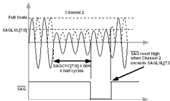
如上图所示，当电压有效值小于跌落电压阈值寄存器（SAGLVL）中设定的阈值并且跌落时间超过跌落线周期寄存器（SAGCYC）中的设定时间（图示为超过第 6 个半周期后， $SAGCYC[7:0]=06H$ ），线电压跌落事件通过设置中断状态寄存器中的 SAG 标志位来记录下来。如果中断屏蔽寄存器（MASK）中相应的 SAG 使能位置为逻辑 1，则/IRQ 逻辑输出变为有效低电平。
