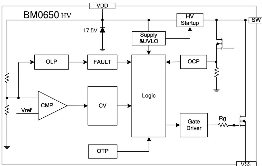
最大0.5A输出, 0.6A限流保护, 静态电流只有几十微安, 适合电池供电
