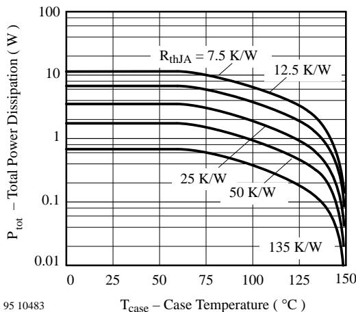
Figure 7.  $P_{tot}$  vs.  $T_{case}$
