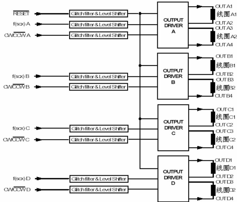
电路所有的输入端都包括一个滤波器和电压转换器。滤波器可以有效防止短时脉冲干扰信号对输入的影响。电压转换器可以使电路工作在更高的电压VDD（相对于前级电路）下，使马达具有更高的扭矩水平。
