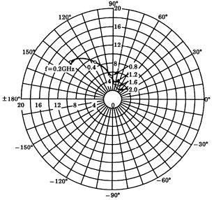
$S_{12e}$   $V_{CE}=6V$   $I_{C}=3mA$   $Ta=25^{\circ}C$
