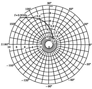
$S_{12e}$   $V_{CE}=5V$   $I_{C}=5mA$   $Ta=25^{\circ}C$
