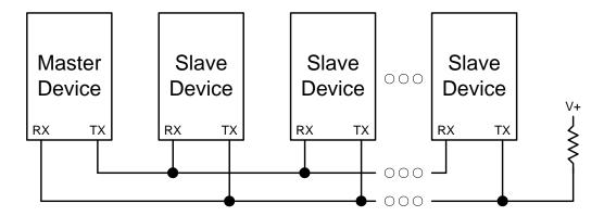
Figure 31.5. UART Multi-Processor Mode Interconnect Diagram
