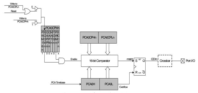
Figure 33.10. PCA 16-Bit PWM Mode
