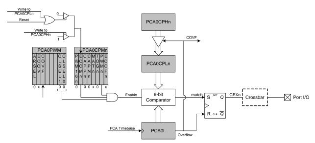
Figure 33.8. PCA 8-Bit PWM Mode Diagram
