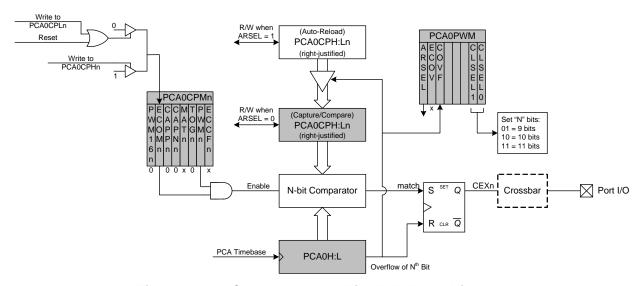
Figure 33.9. PCA 9, 10 and 11-Bit PWM Mode Diagram
