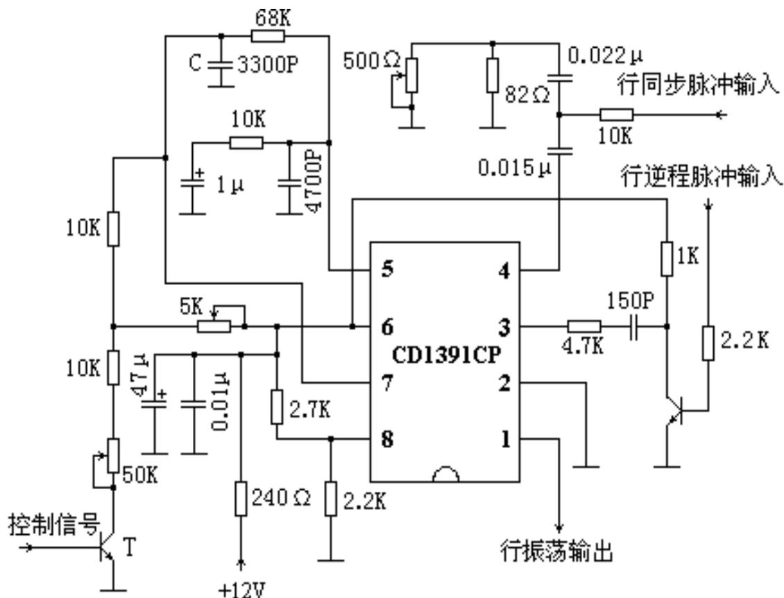
控制三极管 T 的导通或截止,能调节电容 C 的充电电流,从而改变振荡周期。(1) T 饱和,则 10K+50K 电阻接入振荡回路, C 的充电电流减小,电容 C 充电到所要求的峰值电压的时间增加,即自由振荡频率变小。(2) T 截止,则 10K+50K 电阻从振荡回路断开,电容 C 的充电电流加大, C 充电到所要求的峰值电压的时间减少,即自由振荡频率变高。
