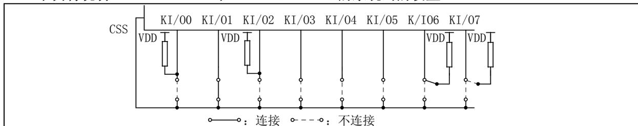
系统码高 8 位中的 C0、C1、C2 是由 KI/O0~KI/O7 中的某一位与 CCS 端相连决定的，所以上例的系统码设置中，C0、C1、C2 应该为 1、0、0。
