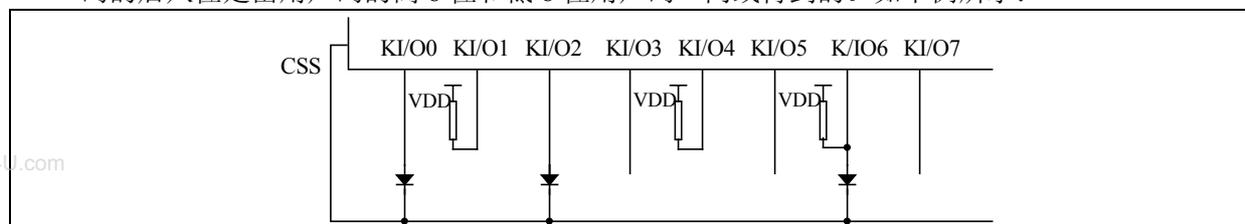
KI/O<sub>n</sub> 接上拉电阻，低 8 位用户码'相应位为“1”。如上图所示键盘的外接方式对应选择码为：
