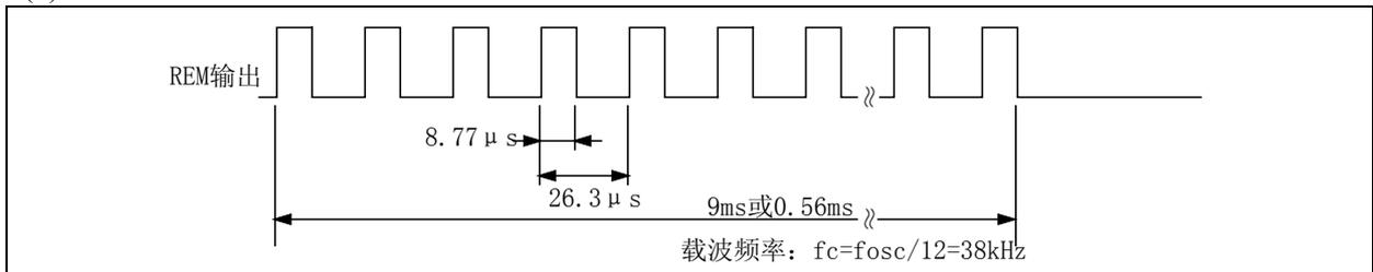
说明：如果按键一直接着，第二个和其后的时间内，仅发射引导码和停止位，将使远红外二极管处于节能状态。
