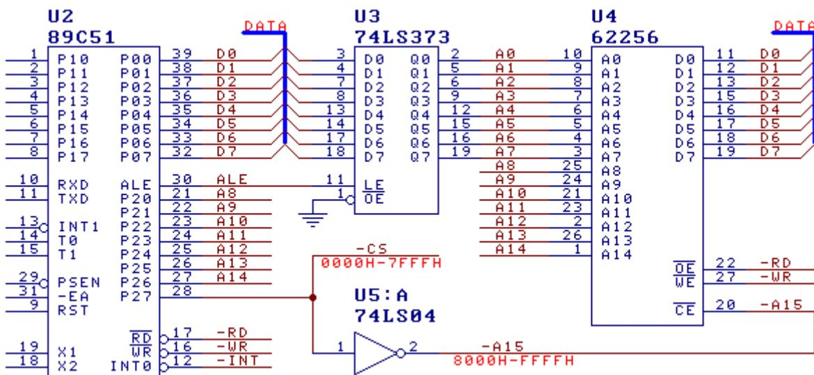
CH372 芯片具有通用的被动并行接口，可以直接连接多种单片机、DSP、MCU 等。在常用的 MCS-51 系列单片机的典型应用电路中，CH372 芯片可以通过 8 位被动并行接口的 D7~D0、-RD、-WR、-CS、A0 直接挂接到单片机 U2（型号是 89C51）的系统总线上。
