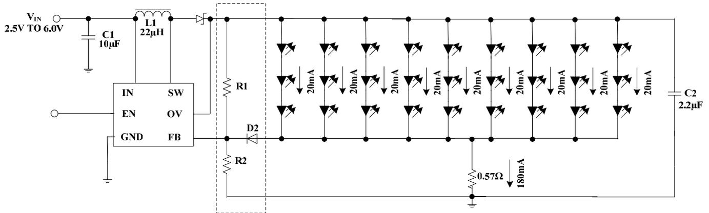
该芯片有内部的 OVP 保护电路，OVP 保护电压设定在 40V。同时也可以通过外围电路实现 OVP 可调。上图中虚线框内通过两个电阻和一个二极管可以实现 OVP 电压可调。
