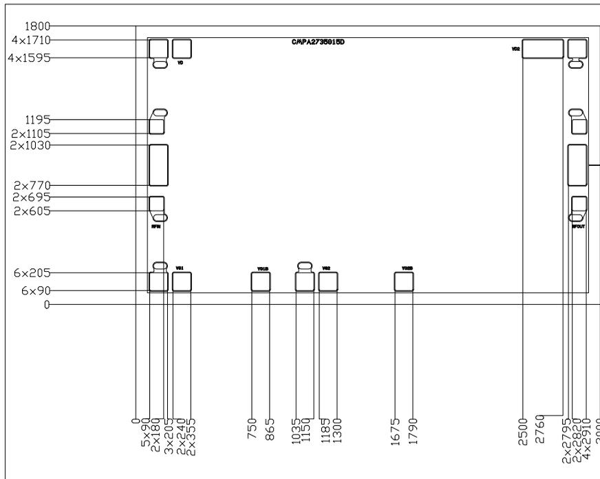
Overall Die Size 2000 X 3000 (+0/-50) Microns, Die Thickness 100 (+/-10) Microns.
