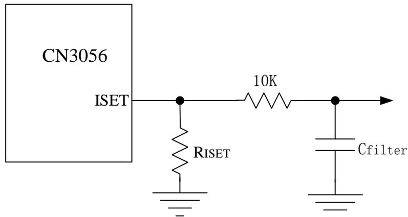
图5 隔离ISET管脚的电容负载
