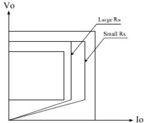
图 3 输出功率随  $R_S$  变化曲线
