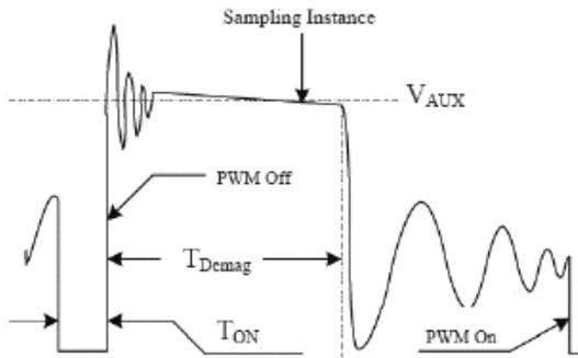
图 4 辅助绕组电压波形图
