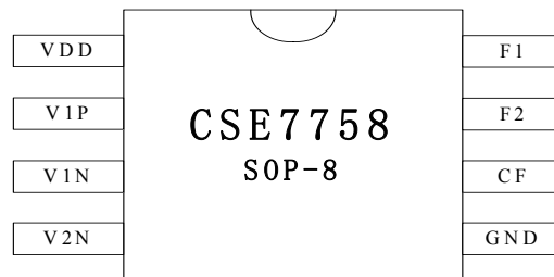
图2. CSE7758 管脚图（顶视图）
