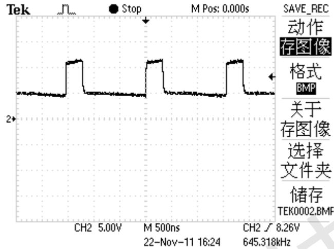
图 1 快冲模式开关驱动波形
