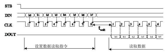
因为DOUT 管脚为N 管开漏输出,所以该脚要连接一个外部上拉电阻( $1K\Omega$ 到 $10K\Omega$ ) 读取数据时,从串行时钟CLK 的第8 个上升沿开始设置指令到CLK 下降沿读数据之间需要一个等待时间tWAIT(最小 $1\mu$ S)。
