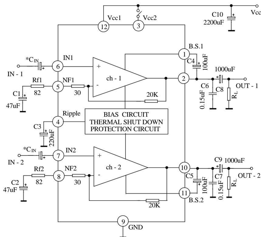
注：此电路在应用中可以不用耦合电容（ $C_{IN}$ ），如果音量电位器产生的噪声大于此电路的输入失调电压，则需要使用耦合电容（ $C_{IN}$ ）。
