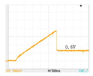
启动后不能正常工作,导致电路最终进入保护状态,PIN14 TIMR 启动前后的波形变化如下:
