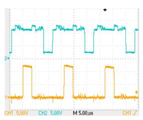
形,推荐采用 27 Ω 的电阻串联在 PIN1 (NDRV),10 Ω 的电阻串联在 PIN16 (PDRV)和相应的 MOS 驱动引脚之间进行缓冲隔离,以提高系统的稳定性。12V 时的两个输出驱动波形如图所示。
