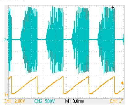
图中通道 1--CH1(下)为多重启动下的 0—3V的 CMP 电压,
