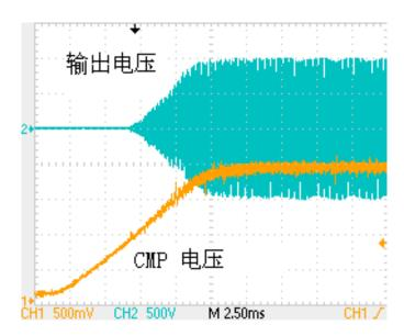
由于软启动的存在,变压器的输出电压(CH2)也随着 CMP 电压的逐渐上升 也呈现出一定的上升梯度。
