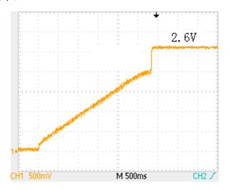
正常工作中,如果出现异常如灯管移去失去灯电流、OVP产生过电压信号等,都会使得PIN14上的电容重新开始充电,导致电压从0.6V开始升高,如果电路在一定时间里恢复了正常工作状态,PIN14电压将回到0.6V,反之,电容的持续充电导致PIN14电压再次升高,直至电路的保护性关闭,原理同上。
