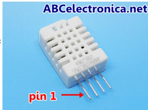
El pin 3 no se utiliza, y se debe de colocar una resistencia de 10K entre VCC y pin salida de datos, de esta manera se coloca en *pull up* y la lectura se hace sin problemas.
