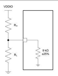
Figure 27. Strap Circuit
