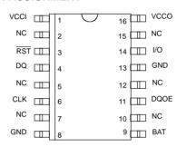
DS1205S 16-Pin SOIC (300 mil) See Mech. Drawings Section
