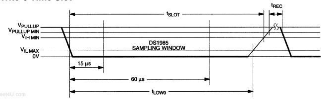
60  $\mu s \leq t_{LOW0} < t_{SLOT} < 120~\mu s$  1  $\mu s \leq t_{REC} < \infty$
