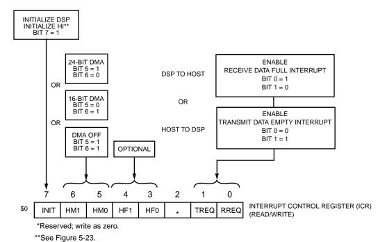
Figure 5-21 (d) HI Initialization — Host Side, DMA Mode
