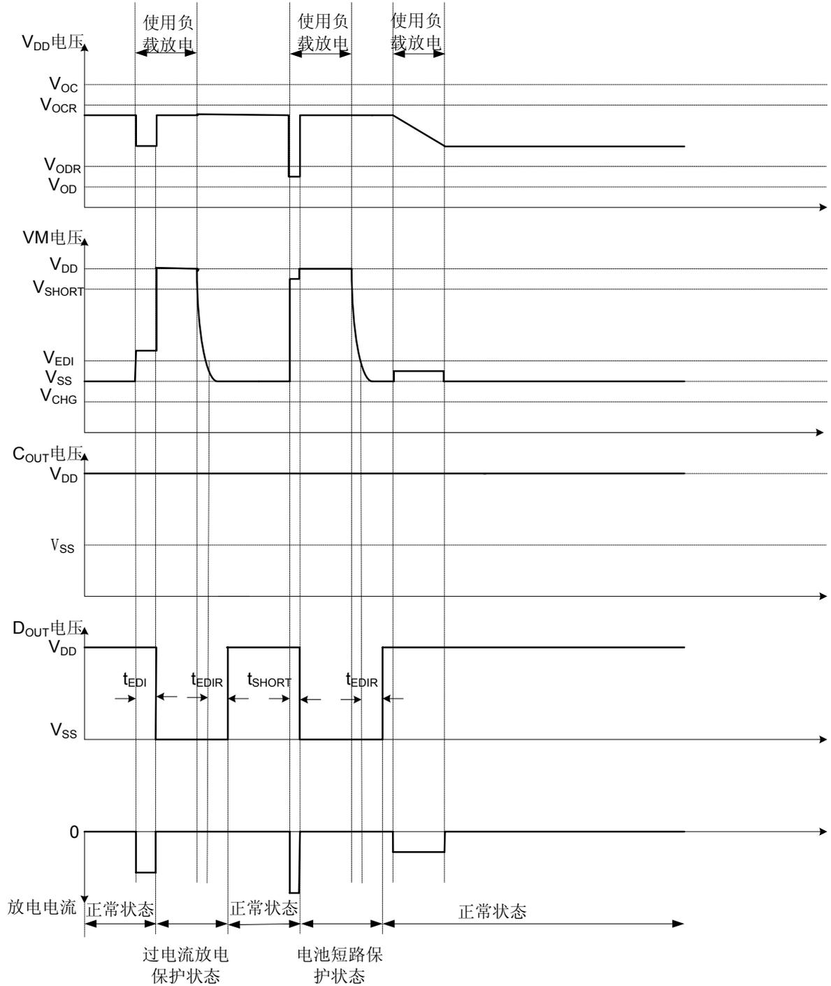
图-6 过电流放电/电池短路保护状态各点波形图
