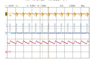
**Load Transient** V<sub>IN</sub>=12V,V<sub>OUT</sub>=1.2V,I<sub>OUT</sub>=0A to 1.5A
