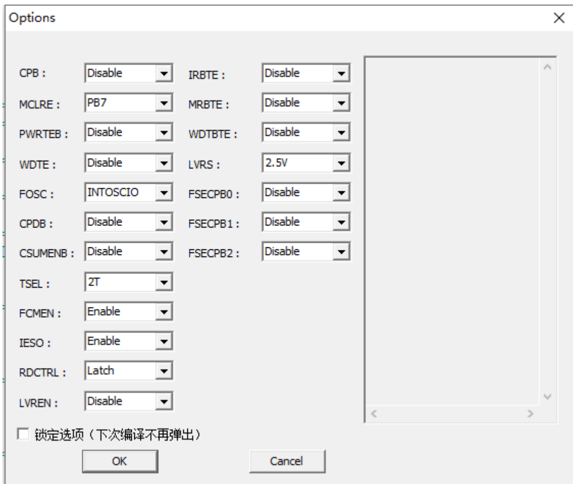
图 13-1 由 IDE 设置的初始化配置寄存器
