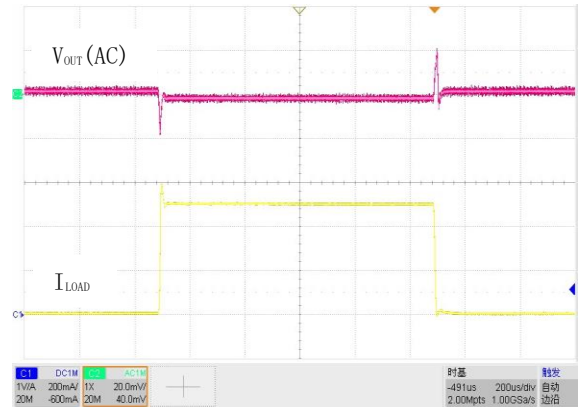
图 23. 负载瞬态响应, V_{IN}=1.2V , V_{OUT}=0.8V , I_{OUT}=1mA to 500mA
