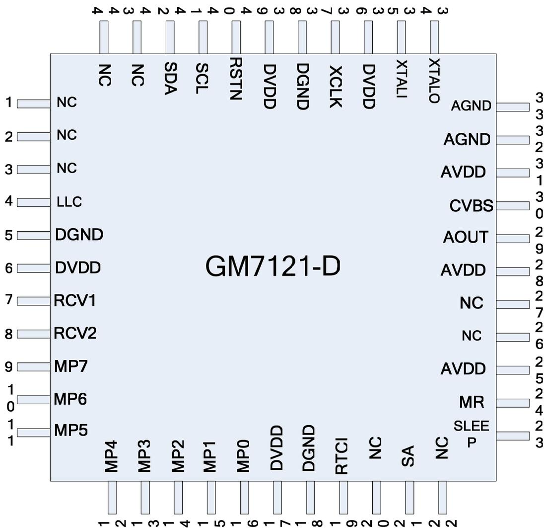
图 1 GM7121—D LQFP44 引脚排布图
