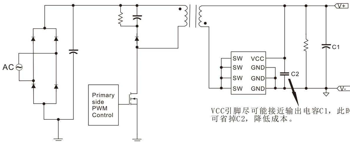
VCC引脚尽可能接近输出电容C1，此时，可省掉C2，降低成本。
