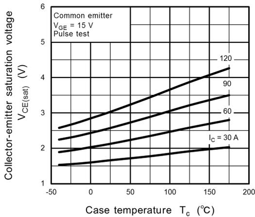
**Fig. 8.5**  $V_{CE(sat)} - T_c$
