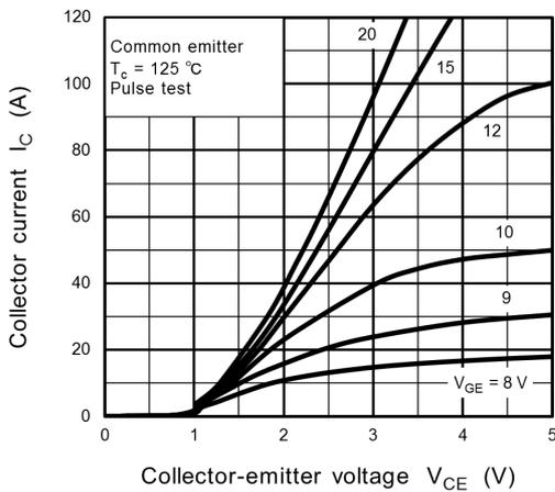
**Fig. 8.3**  $I_C - V_{CE}$
