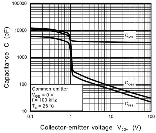
**Fig. 8.8  $C - V_{CE}$**
