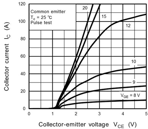
**Fig. 8.2**  $I_C - V_{CE}$
