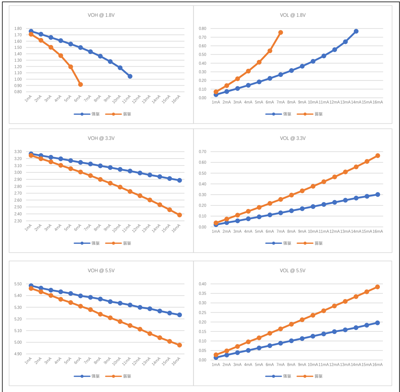
图 7-2 输出端口 VOH/VOL 实测曲线
